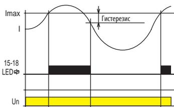
Реле контроля PRI-32 предназначено для контроля уровня токов в однофазных АС цепях. Плавная настройка подаваемого тока позволяет использовать реле в приложениях с необходимостью индикации проходящего тока, используется также как реле выбора. Выходное реле в нормальном состоянии разомкнуто. При превышении настроенного уровня силы тока реле замыкнется. Выгодой в данном случае является универсальное напряжение питания.
