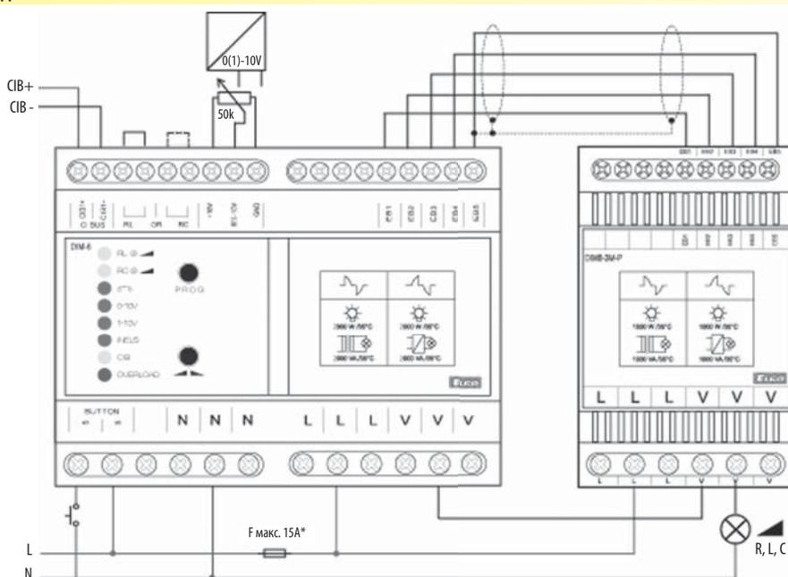
\* Потенциал L на клемме устройства необходимо обеспечить защитой, соответствующей подключенной нагрузке.
